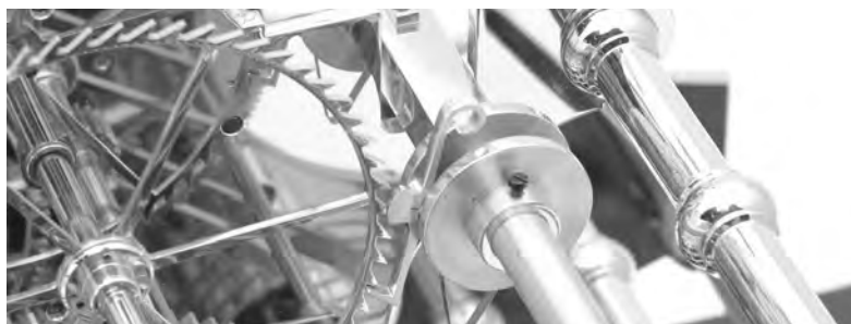
Figura 35. Detalle del escape saltamontes en el H1
