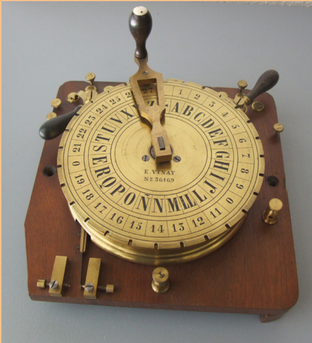
Telégrafo de cuadrante Breguet. Transmisor. 1845 Sala de Telegrafía Siglo XIX Museo Postal y Telegráfico Febrero 2024
